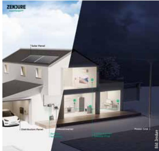
SolarFlow ergänzen neue AB2000-Batterien (zu 1.920 Wh) die bisherigen AB1000-Batterien mit 960 Wh und gestatten damit eine größere Speicherkapazität – es lassen sich bis zu vier Batterien miteinander zu einem Akkupack verbinden, womit den Haushalten eine maximale Speicherkapazität von 7.680 Wh bereit steht.
